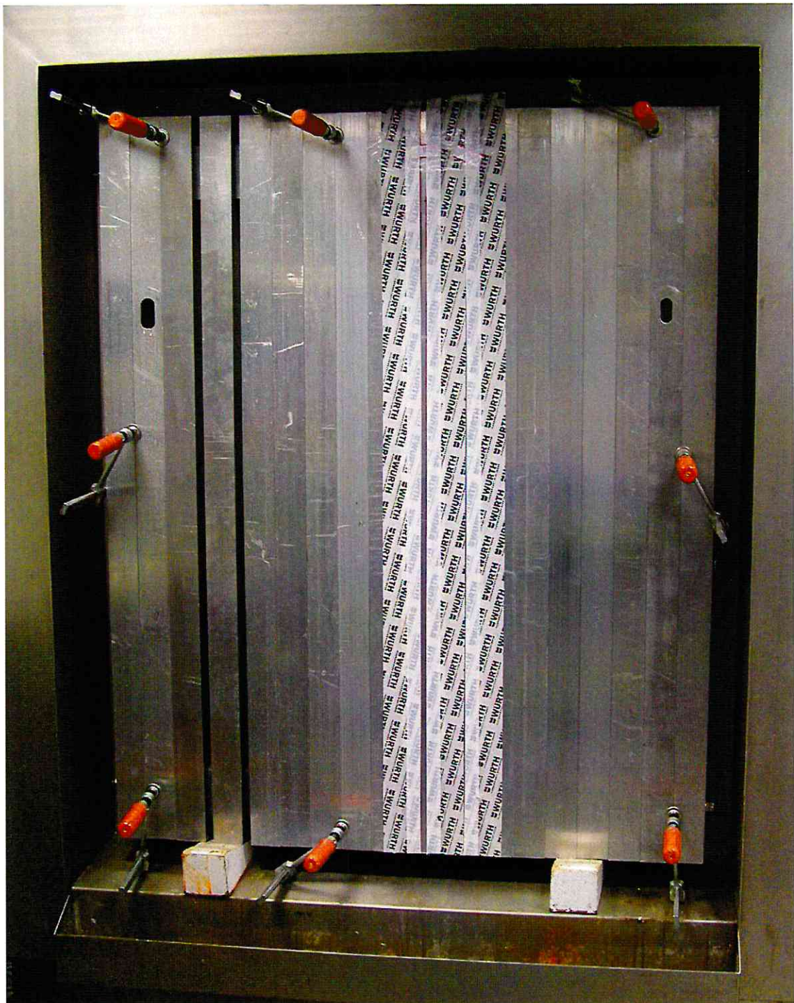
Bild 6: In den Versuchsstand eingebauter Prüfkörper
