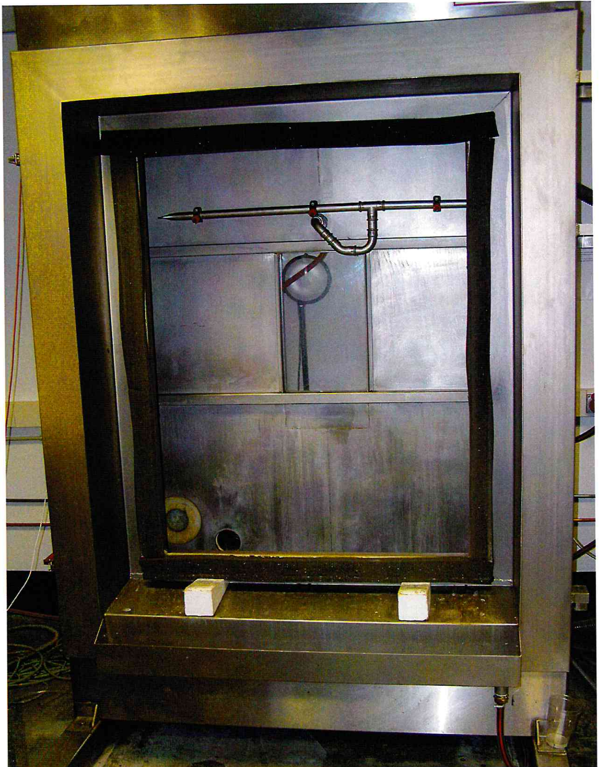
Bild 1: Offener Prüfstand ohne den eingesetzten Versuchskörper
