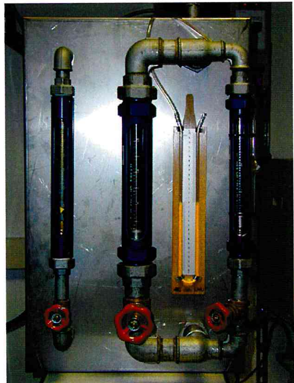
Bild 3b: Prüfstand-Steuerung (Wasser- u. Luftmenge)
